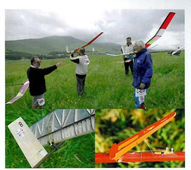
gewinn sind geschätzte drei bis fünf Meter. Und für das Auslösen der Thermikbremse ist seit einigen Jahren von der CIAM auch ein Funksignal erlaubt. Das musste realistischerweise früher ein codiertes sein, weil bei einer herkömmlichen RC-Anlage immer die Gefahr bestanden hätte, dass ein RC-Pilot am Nachbarhang den Wertungsflug vorzeitig beendet. Mit einer preiswerten 2,4 GHz-Anlage ist diese Sorge überflüssig geworden.
